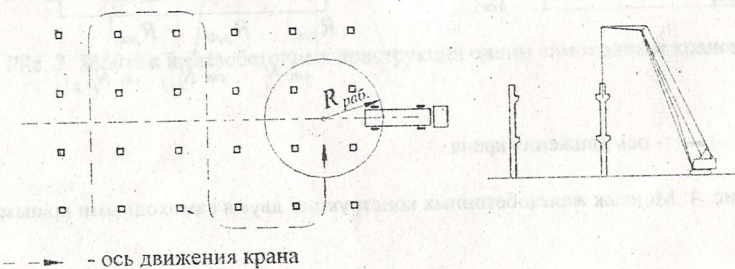
Рис. 7. Монтаж колонн нижнего яруса самоходным краном
